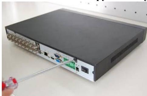
Открутите винты крепления крышки на нижней части корпуса.
